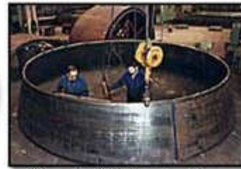
Cône dia. 8000mm ép. 40mm
