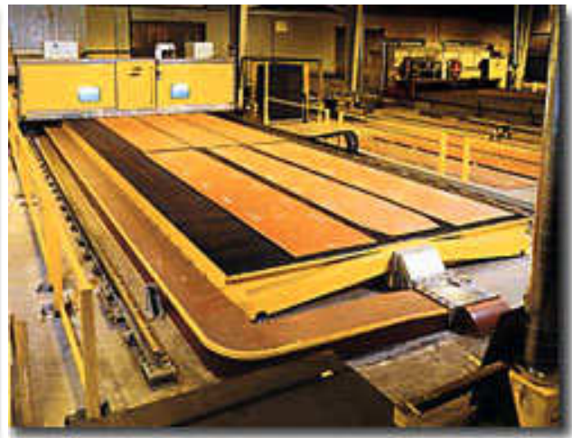
Epaisseur maxi 25 mm, largeur 4800 mm, longueur 24200 mm
