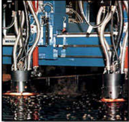
Découpe au PLASMA immergé jusqu'à 30 mm d'épaisseur
