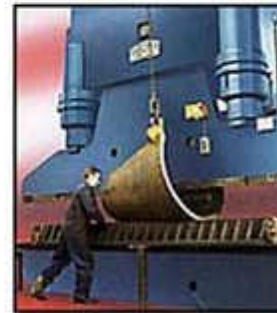
Cône dia. 8000mm ép. 40mm
